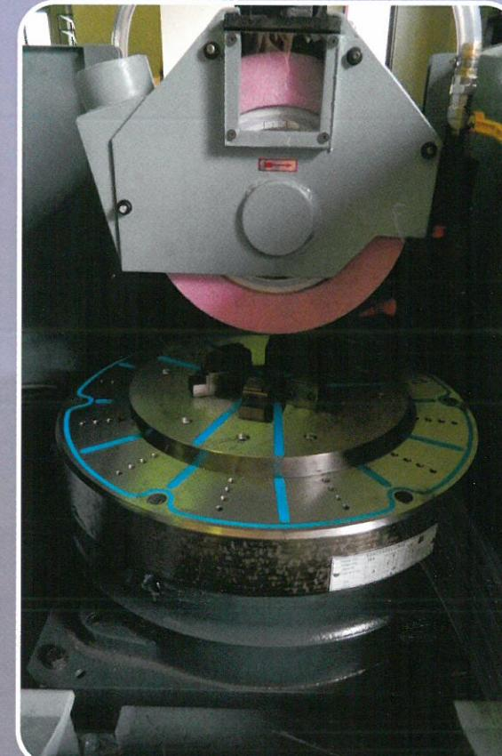
La rectifieuse de surface planes à meule tangentielle et plateau tournant type RTC a été conçue dans le but d'obtenir un rendement élevé et une précision maximale, celle-ci se présentant sous les aspects de la planéité, du parallélisme et de l'état de surface.
